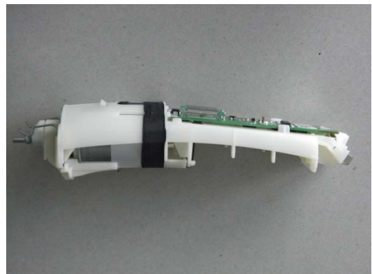
GT410875 Innenträger inkl. Motor und Platine
